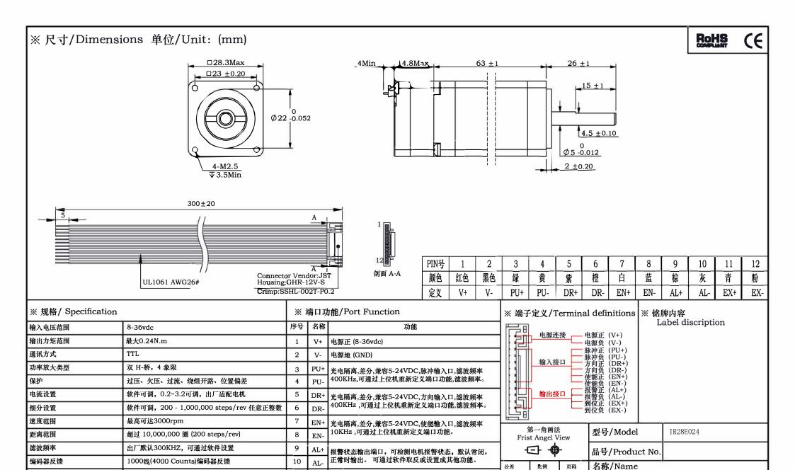
**到位**输出端口,可检测电机运行状态,默认常开,到位时输出。 可通过软件取反或设置成其他功能。
